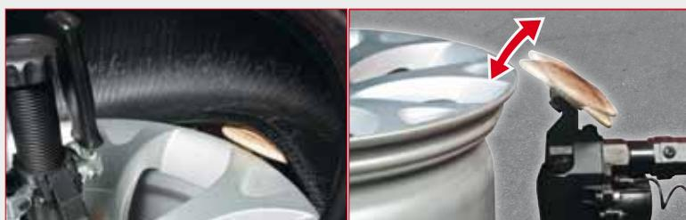
**Procédure rapide** de démontage du deuxième talon, rendue possible par le **mouvement du disque breveté**, particulièrement adaptée pour les pneus à flancs durs.
