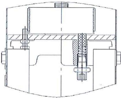
Die mechanische Gleichlaufregelung wird in die vorhandene Bohrung in der Kopfplatte montiert.
