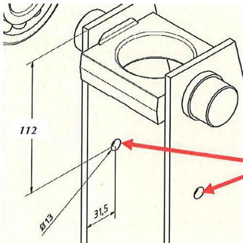
Bei Hebebühnen mit Baujahr vor dieser Änderung müssen Bohrungen im Hubwagen hergestellt werden.
