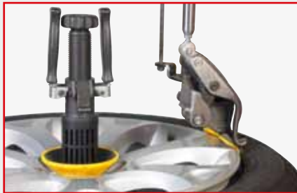
Demontage der oberen Wulst
