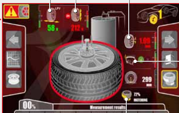
LFV Laterale Kraftschwankungen
