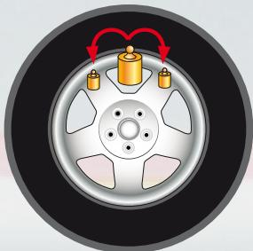
Parfaite esthétique de la jante parce qu'elle permet de diviser la masse adhésive d'équilibrage du flanc externe en deux masses équivalentes placées en position cachée derrière les rayons
